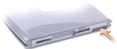
4. Tire del dispositivo sujetando el pestillo de liberación para extraer el dispositivo D/Bay.
