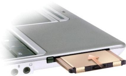
El equipo reconoce la mayoría de las tarjetas PC y carga automáticamente el controlador de dispositivos adecuado. Si el programa de configuración le pide que cargue los controladores del fabricante, utilice el disco o el CD incluido con la tarjeta PC.
