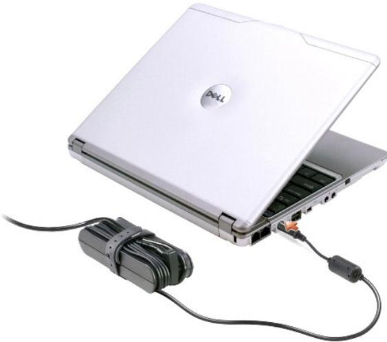
**PRECAUCIÓN:** si utiliza una caja de contactos múltiple, tenga cuidado al enchufar el cable de alimentación de CA en ella. Algunas cajas de contactos permiten realizar conexiones erróneas. La conexión incorrecta del enchufe podría provocar daños irreparables en el equipo, además del riesgo de sufrir una descarga eléctrica u ocasionar un incendio. Asegúrese de que la clavija de toma de tierra del enchufe de alimentación está insertada en la conexión de toma de tierra de la caja de contactos.
