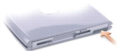
2. Tire del dispositivo sujetando el pestillo de liberación para extraer el dispositivo D/Bay.
