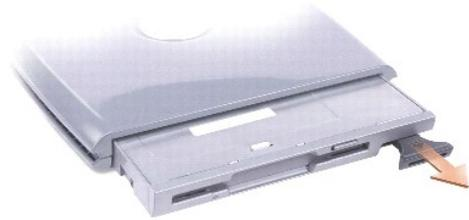
5. Inserte el nuevo dispositivo en el compartimiento, empuje el dispositivo hasta que oiga un clic y presione el pestillo de liberación del dispositivo para que quede alineado con el equipo.
