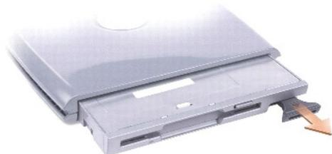
5. Inserte el nuevo dispositivo en el compartimiento, empuje el dispositivo hasta que oiga un clic y presione el pestillo de liberación del dispositivo para que quede alineado con el compartimiento.
