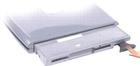
3. Inserte el nuevo dispositivo en el compartimento, empuje el dispositivo hasta que oiga un clic y presione el pestillo de liberación del dispositivo para que quede alineado con el compartimento.
